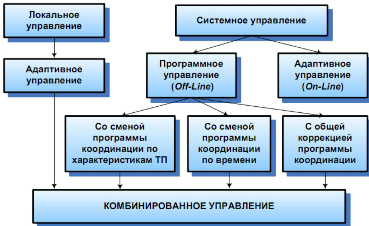
Рисунок. Классификация методов управления транспортными потоками
